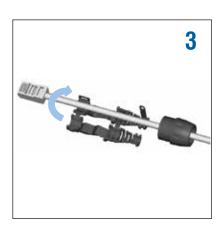
Install the cable clamp-boot.
