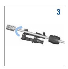
Install the cable clamp-boot.
